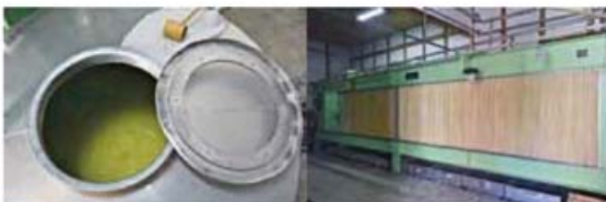
蒸米機(右)や製麹機は自社開発。昔ながらの作り方による味を再現できるように試行錯誤を繰り返した苦労話を聞くと、「機械化」という素っ気ない言葉では表現できない。冬場は毎日続く仕込みも、日々の微調整は杜氏たちの経験による。
