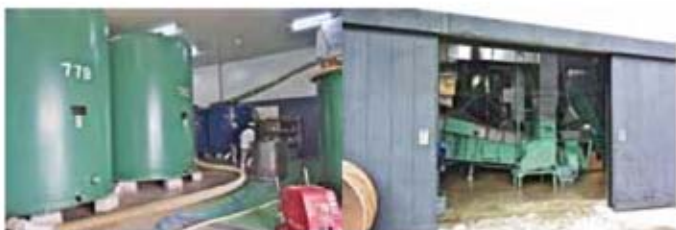
蒸米機(右)や製麹機は自社開発。昔ながらの作り方による味を再現できるように試行錯誤を繰り返した苦労話を聞くと、「機械化」という素っ気ない言葉では表現できない。冬場は毎日続く仕込みも、日々の微調整は杜氏たちの経験による。
