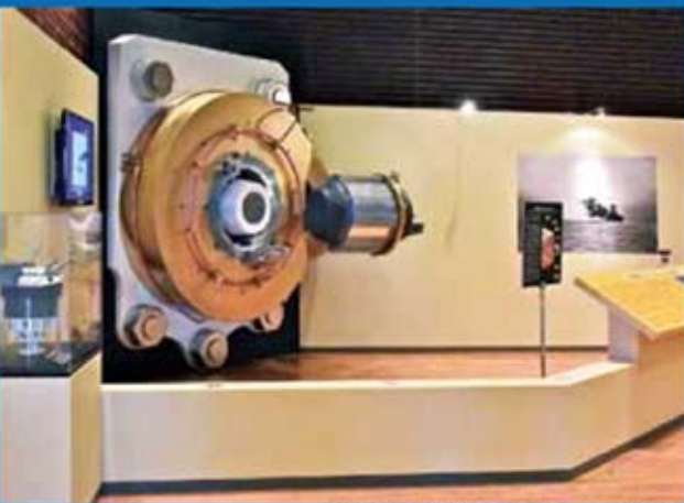
展示の目玉は大和の主砲砲尾部分を再現した実物大模型。世界最大の46センチ主砲の大きさ、その爆圧に耐える強固な構造は圧巻。
