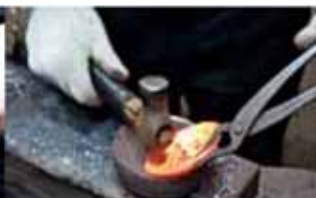
1枚1枚手で模様が開けた鉄板を焼き、椀型に打っていく。
