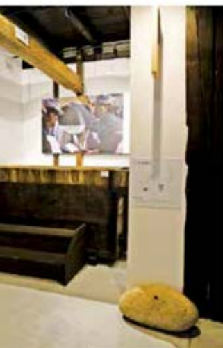
発酵の終了したもろみを押るハネ木搾り。上部の巨大なハネ木と下の大きな石をテコに用いた。
