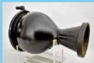
局地戦闘機「秋水」のエンジンノズル。B29に対抗する航空機として陸海軍共同で開発された。ドイツの潜水艦のロケットエンジンを参考に造られ、強度を要するノズルは鋳物製。製造と解体に関わった人が保管していたものを同館に寄贈。
